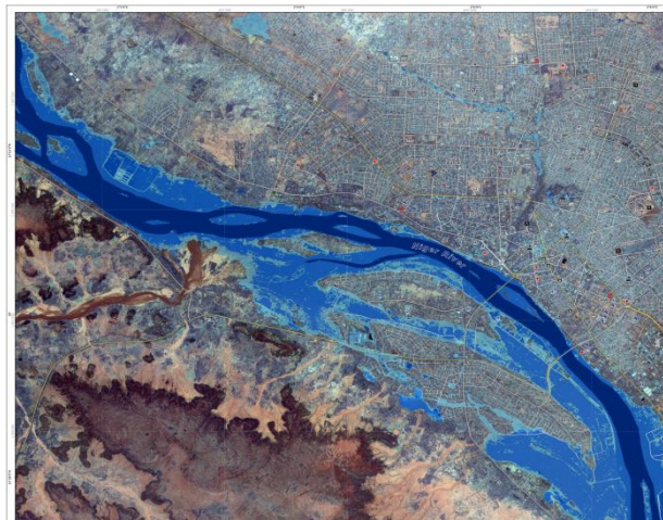
Figure 9 : Extension de l'inondation dans le secteur de Niamey telle qu'observée à partir des données Kompsat 2, acquise le 1 er Septembre 2012 (échelle originale 1 :20000)
