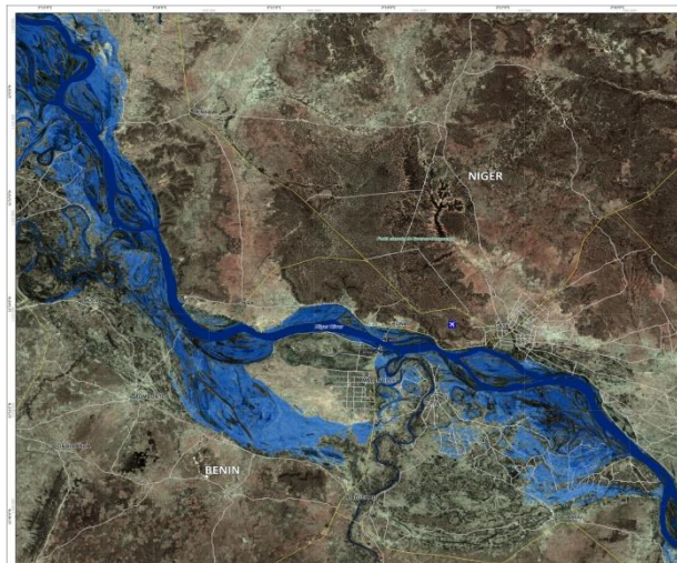
Figure 8 : Carte générée au 1:2500 présentant l'extension des inondations du fleuve Niger dans le secteur de Gaya à la frontière du Niger et du Burkina-Fasso telle qu'observée à partir de données Radarsat et Cartosat1 acquises le 8 Septembre 2012.
