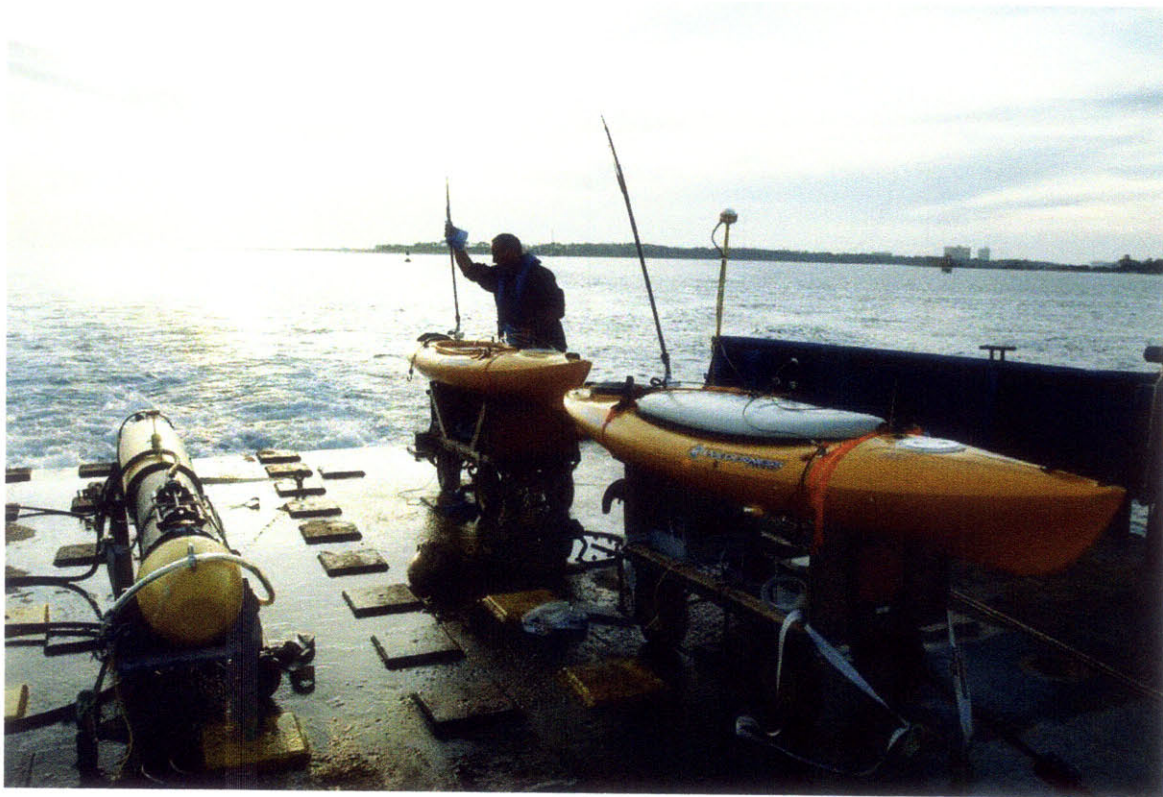
Figure 5-7: Two MIT ASCs and one Bluefin 12" AUV.
