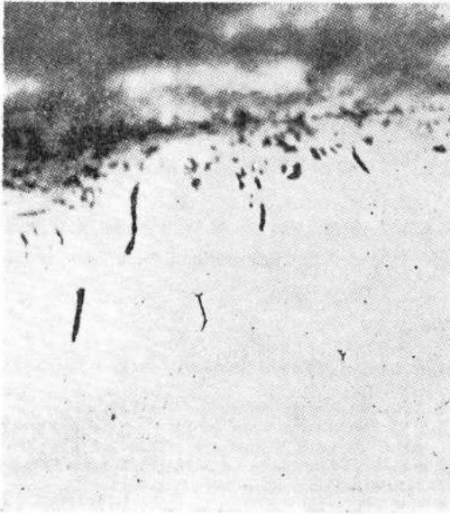
図16 Uベンド試験片表面に生じた粒界割れ 腐食液：10%クロム酸中電解。250×
