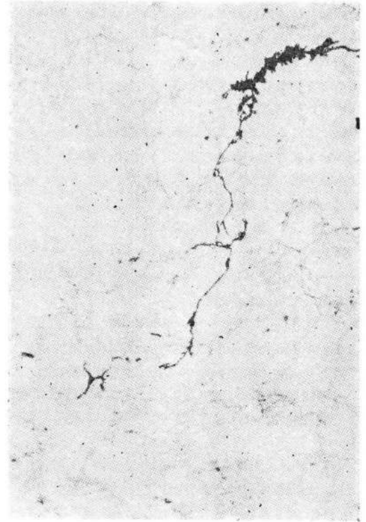
図17 溶接後時効処理した試験片の粒界割れの伝播 腐食液：10%クロム酸中電解。750×
