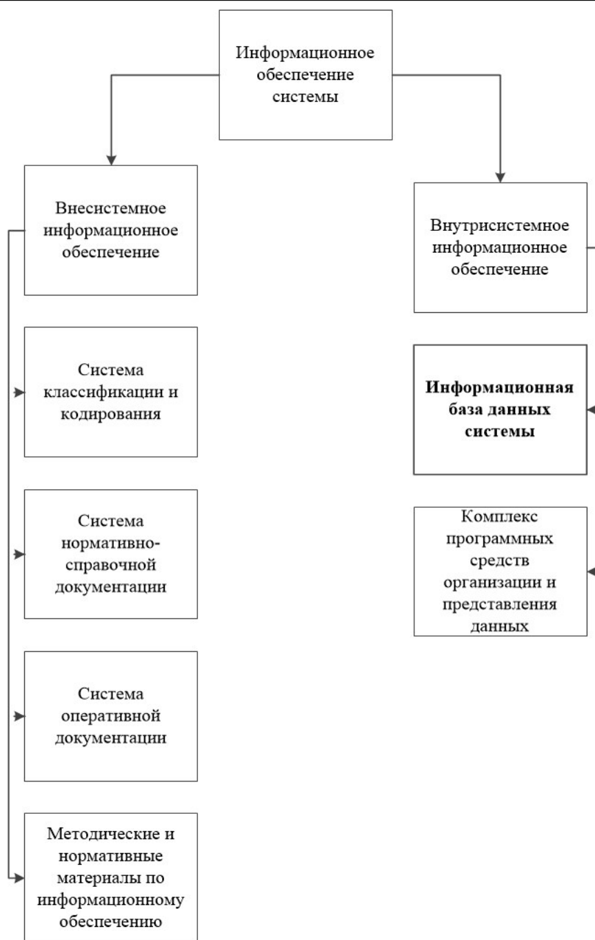
Рис. 1. Схема информационного обеспечения систем автоматизации предприятия
