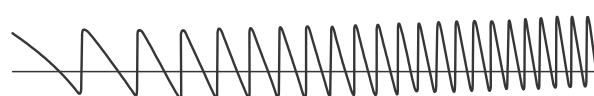
Рис. 5. Общий вид профиля дифракционной линзы с фокусным расстоянием 70 мм и диаметром 10 мм
