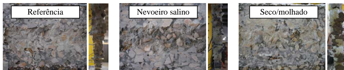
Figura 5. Pós-rotura de compósitos de GFRP de vigas referência e sujeitas a 10000h de ciclos de nevoeiro salino e seco/molhado (tipo marés).
