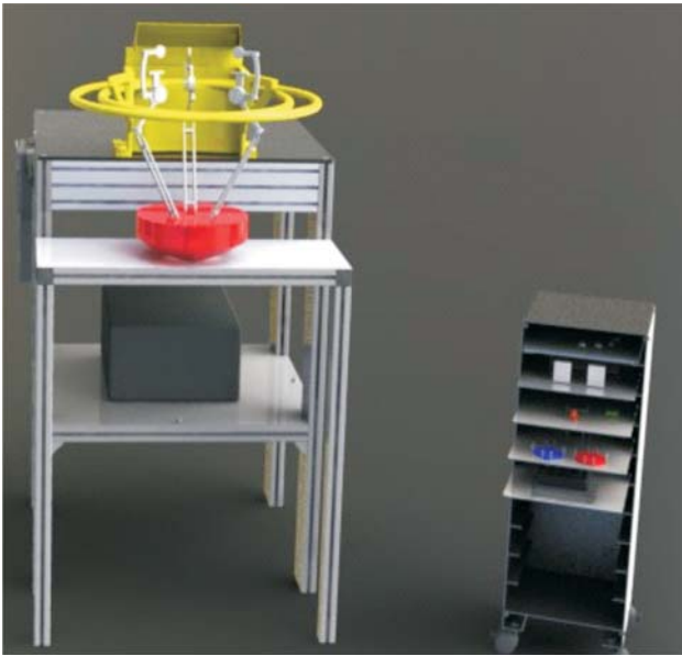
Figure 21 Design of workplace with FANUC Delta robot M-1iA [4] Slika 21. Projekt radnog mjesta s FANUC Delta robotom M-1iA [4]
