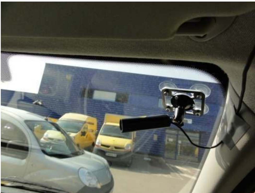
Figure 1. Caméra embarquée filmant l'activité de l'opérateur dans le poste de conduite
