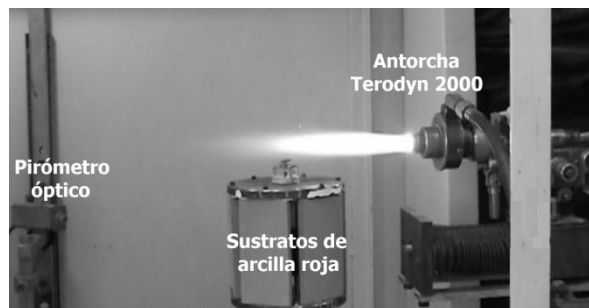
Fig. 1. Imagen del porta-muestra y de antorcha Terodyn 2000™. Fuente: Grupo GIPIMME Universidad de Antioquia
