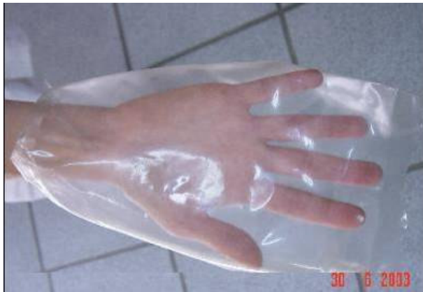
Figura 2.6 – Filme produzido a partir de amido.
