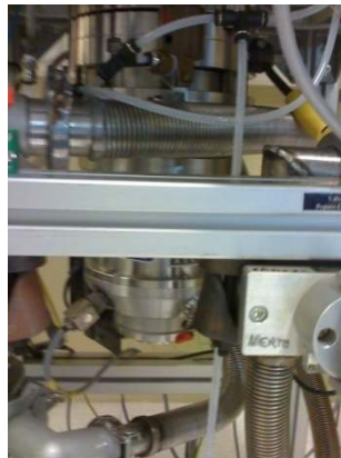
Figura 3.9. Pormenor do sistema de vácuo onde se pode ver a Bomba turbomolecular.
