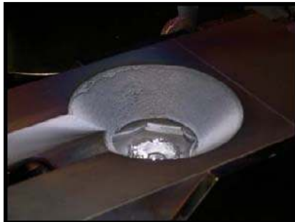
Figura 3.7. Foto da unidade de evaporação onde se pode ver um dos 4 cadinhos existentes no sistema utilizado.
