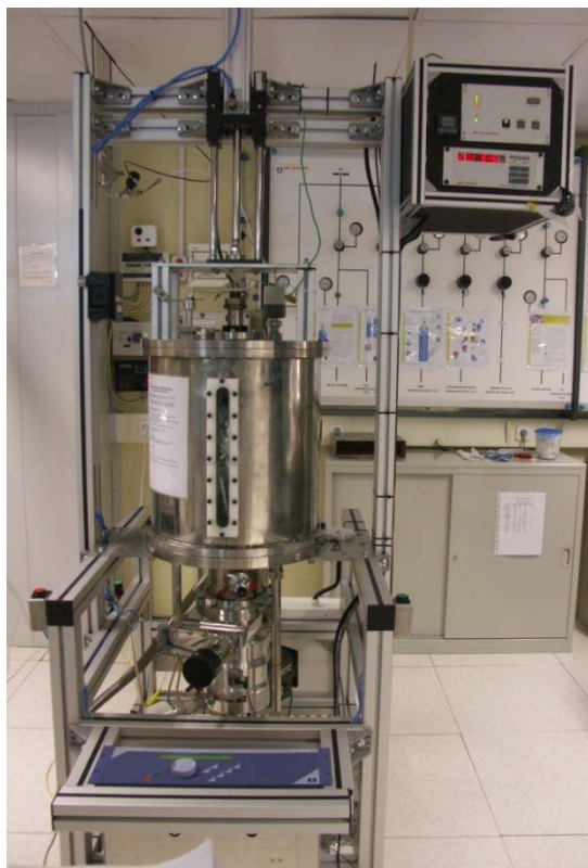
Figura 3.3. Sistema de Pulverização catódica reactiva de rádio frequência existente na câmara limpa do CEMOP.
