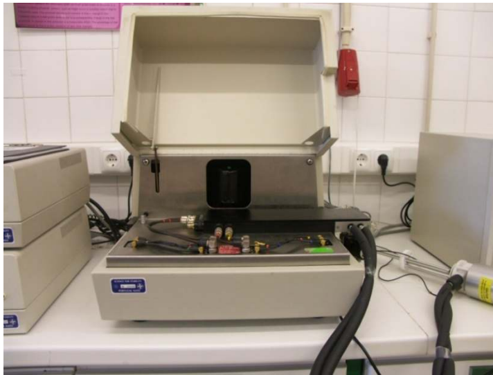
Figura 4.4. Sistema Biorad HL 5500 utilizado nas medidas de resistividade e efeito de Hall.
