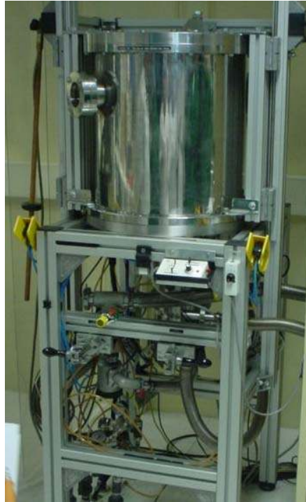
Figura 3.5. Foto do equipamento de deposição por feixe de electrões utilizado existente na câmara limpa do CEMOP.
