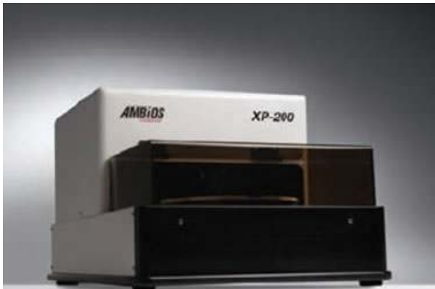
Figura 4.1. Perfilómetro Ambios XP-200 existente no CENIMAT.
