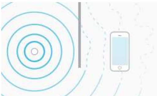
Figura 3.14 – Atenuação de sinal por objetos físicos
