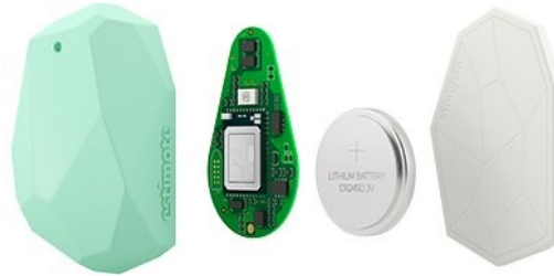
Figura 3.19 – Conteúdo no interior de um beacon
