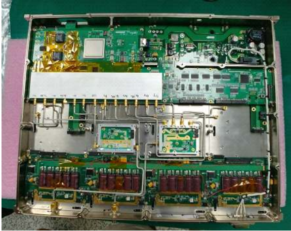
그림 11. 디지털 송수신모듈 전체 조립형상 Fig. 11. The complete inner shape of the TR-module.
