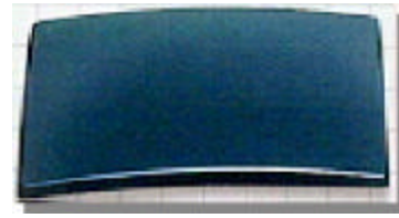
Fig. 12. Die of shadow mask.
