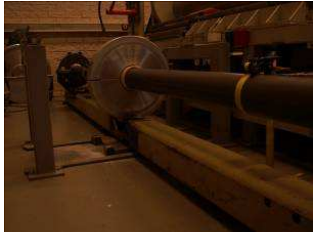
(d) A 110 mm PN10 PVC pipe ready to be tested.
