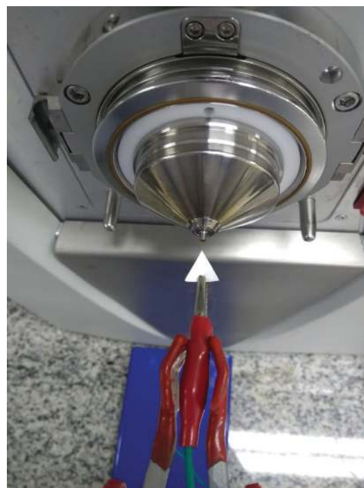
Figura 3. Sistema MIP-PSI homemade acoplado ao espectrômetro de massas LCQ Fleet
