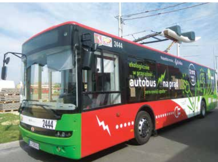
Autobus elektryczny Ekovolt marki Ursus (generacja 1) podczas podjazdu do ładowania pantografem
