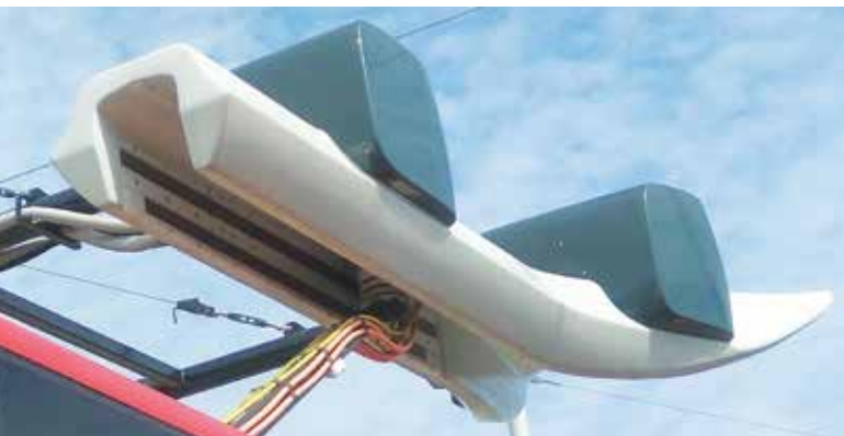
Szybkie ładowanie za pomocą pantografu
