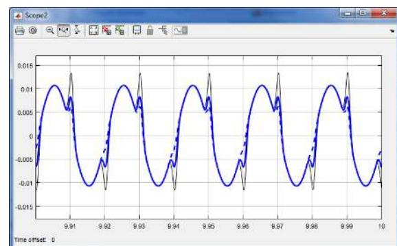
Рис. 8. Кривые установившегося тока холостого хода насыщенного трансформатора
