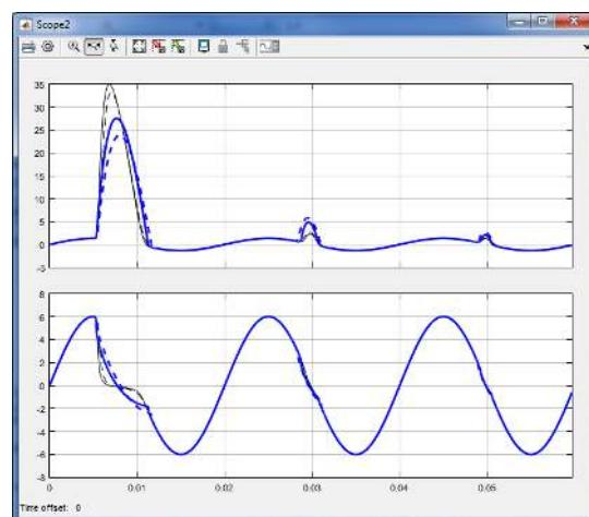
Рис. 10. Кривые пуска насыщенного трансформатора под нагрузкой (увеличенено)
