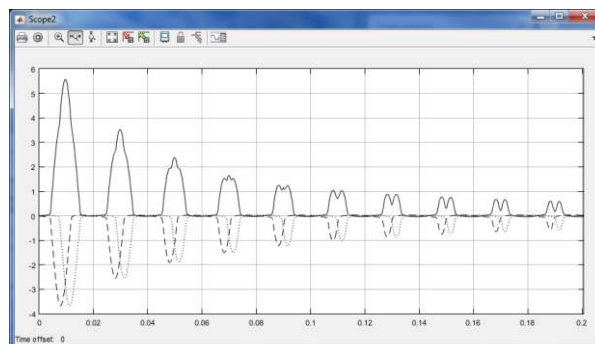
Рис. 9. Кривые линейных токов в первичной обмотке при включении на ХХ
