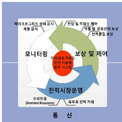
그림 2 마이크로그리드 분산 지능형 관리시스템 개념 Fig. 2 Concept of Microgrid Distributed Intelligent Management System
