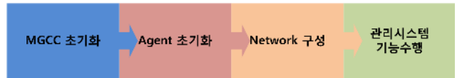
그림 13 마이크로그리드 분산 지능형 관리시스템의 동작 Fig. 13 Operation of Microgrid Distributed Intelligent Management System
