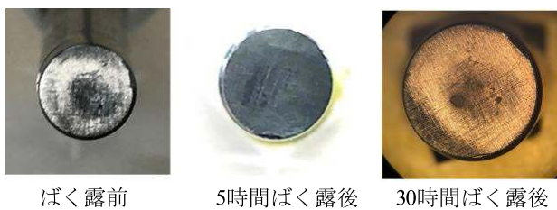
図 16 前面円柱背面凸形前面板を有する第 6 世代堅牢ハイドロホンの超音波洗浄装置内ばく露時間と前面板表面の様子 (転載 Copyright© 2010 IEICE), 出典: 文献 (52) の Fig. 14 からの転載
