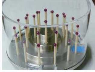
図3 Eテスト用ルビー製長さ評価ゲージ
