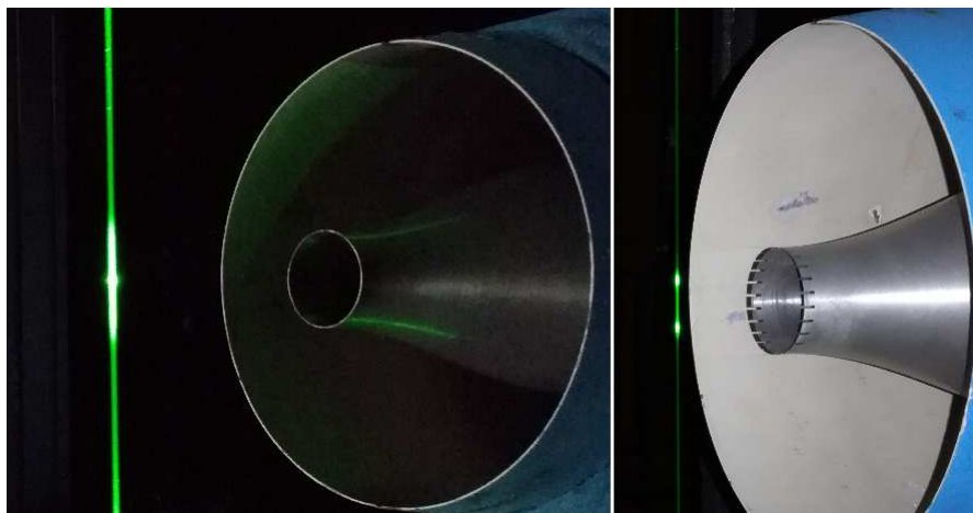
FIGURE 1.7 – Effet de la condensation dans le jet sur le diffusion de la lumière du laser. Les zones qui contiennent le plus de gouttelettes sont caractérisées par une diffusion intense.
