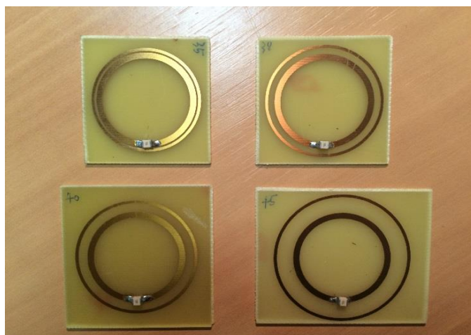
Figure III.17 Antennes LC blindées avec des anneaux de différents rayons, fabriqués en cuivre sur FR4
