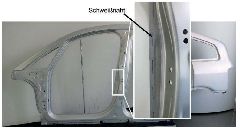
Bild 1.1: Randnahes Schweißen von Aluminiumkarosserien am Beispiel der Seitenwand des Audi A2 Modelles.
