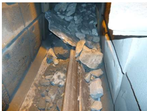
Figura 14: Rasgo de correia por lamela do minério. Fonte: Foto tirada na unidade de britagem analisada
