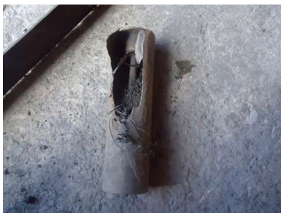
Figura 16: Rolete de transportador de correia danificado. Fonte: Foto tirada na unidade de britagem analisada
