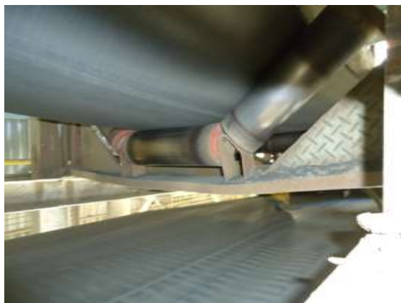
Figura 15: Estrutura física do transportador e sustentação da correia. Fonte: Foto tirada na unidade de britagem analisada
