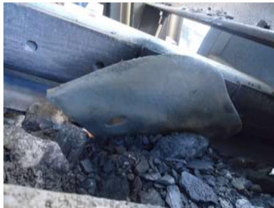
Figura 13: Rasgo de correia por material metálico. Fonte: Foto tirada na unidade de britagem analisada
