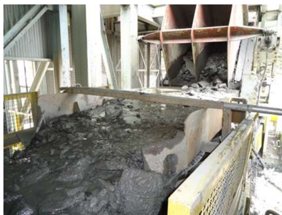
Figura 11: Entupimento por excesso de umidade. Fonte: Foto tirada na unidade de britagem analisada
