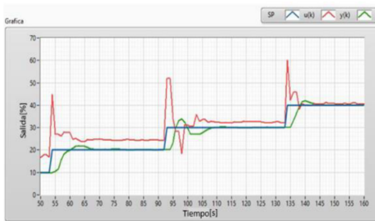
Figura 7. Control STR con el prototipo del generador CD
