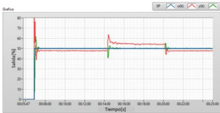
Figura 8. Respuesta del control STR ante una carga
