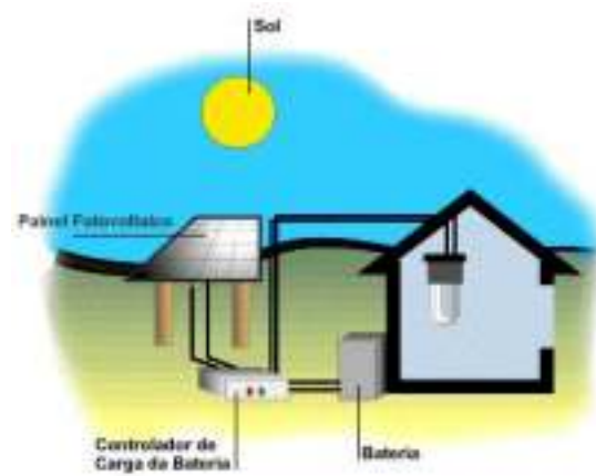
Figura 1.6. Esquema de sistema fotovoltaico autônomo isolado. (CRESESB, 2004)
