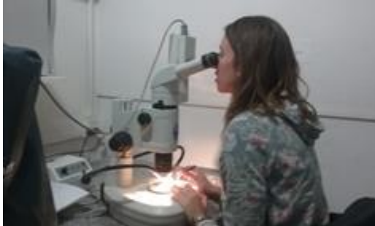
Figura 12. Lupa binocular utilizada para la identificación y cuantificación de los organismos bentónicos.
