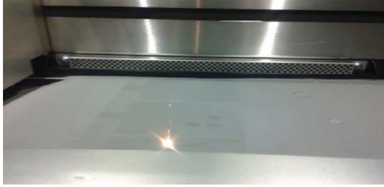
Şekil 5. DMLS cihazında ilk katman toz malzeminin serilmesi
