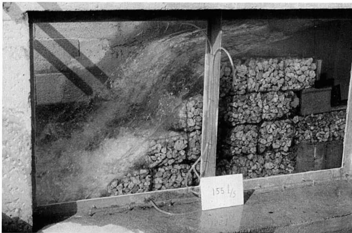
Écoulement très turbulent sur un déversoir de pente 1/1 et de 5 m de hauteur ; gradins en gabions « nus » ; régime torrentiel ; débit 2,17 \text{ m}^3 \cdot \text{s}^{-1} \cdot \text{ml}^{-1} .
