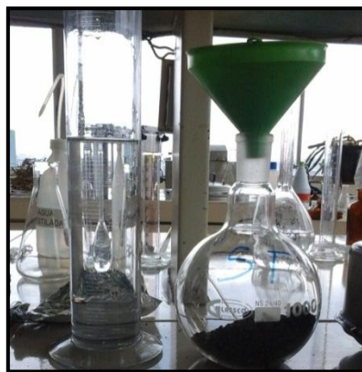
Figura 17. Colocación de los 100 g de polvo de semilla en el balón aforado.
