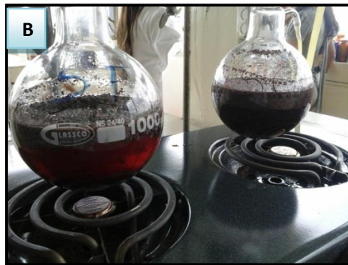
Figura 18. A) Equipo de reflujo. B) Reflujo de la cáscara y semilla de cacao.
