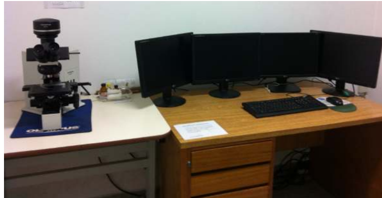
Figura 8 – Microscópio óptico (Olympus BX 50) com câmera fotográfica (Olympus DP-71) acoplada e monitores para análise e morfometria das imagens.
