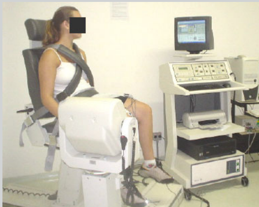
Figura 1 - Posicionamento do participante no dinamômetro isocinético durante a avaliação do torque isocinético.
