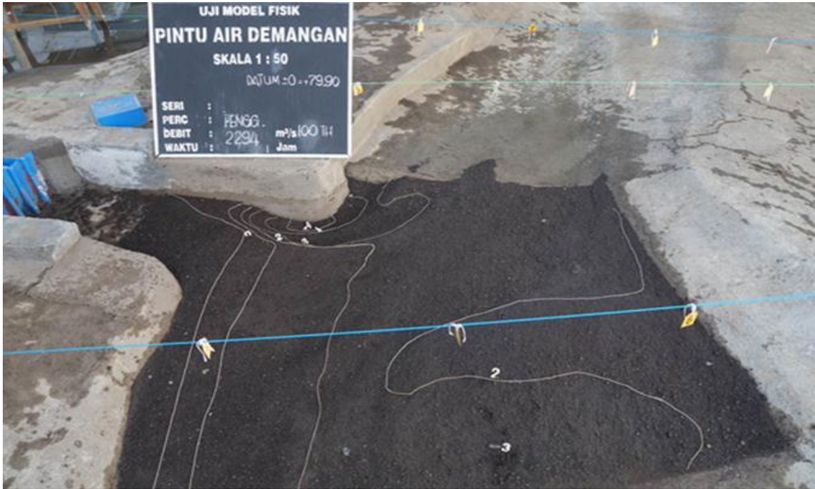
Gambar 10 Pola dan kedalaman gerusan pada kondisi eksisting (Uji Model Fisik, Q_{100th} )
