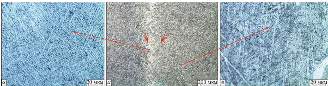
Рис. 7. Микроструктура пластины после отжига: a — \times 50 ; b , v — \times 500
