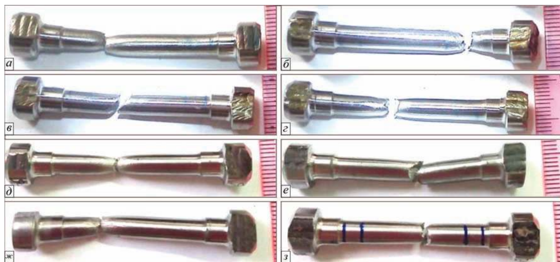
Рис. 2. Разрывные образцы после испытаний из пластины до термообработки (а — 1; б — 3; в — 2; г — 4) и после (д — 5; е — 7; ж — 6; з — 8)
