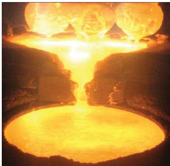
Рис. 3. Процесс электронно-лучевой плавки слитка диаметром 400 мм из первичной шихты
