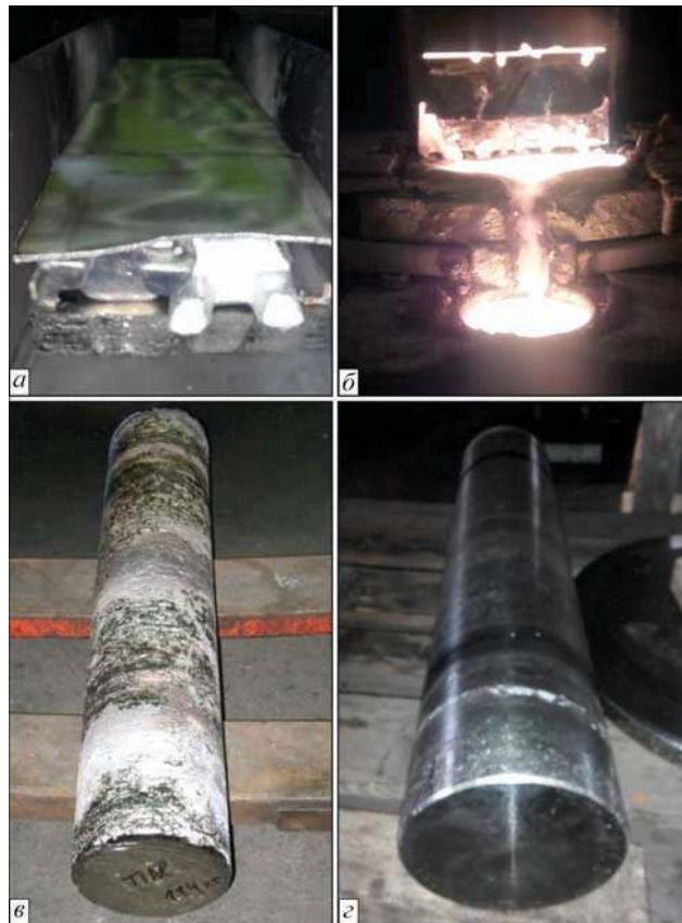
Рис. 2. Внешний вид шихтовой заготовки (а), процесс плавки (б), слиток алюминида титана Ti-29Al после плавки (в) и механической обработки (з)
