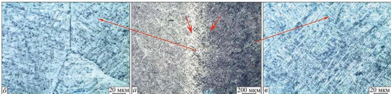
Рис. 6. Микроструктура пластины в исходном состоянии (после наплавки): a — \times 50 ; b , v — \times 500
