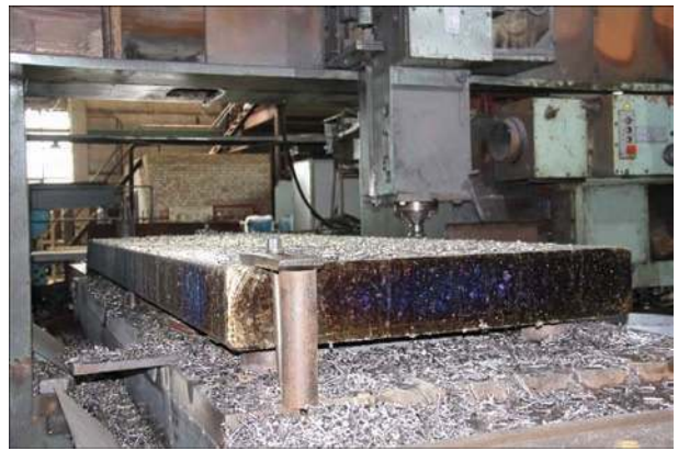
Рис. 2. Механическая обработка сляба размерами 4300×1350×228 мм и массой 5,8 т
