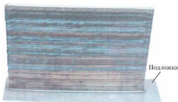
Рис. 1. Внешний вид пластины, полученной плазменной наплавкой в среде аргона с применением проволоки из сплава Ti-6Al-4V
