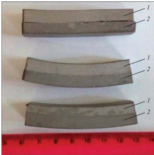
Рис. 2. Внешний вид спеченных двухслойных образцов: 1 — Ti-6Al-4V; 2 — Ti-6Al-4V-10TiB
