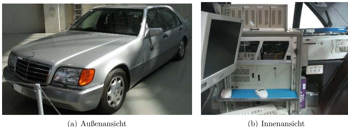
Abbildung 2.1: Versuchsträger VaMP (Versuchsfahrzeug für autonome Mobilität und Rechnersehen im PKW)
