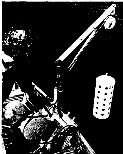
Abb. 4. Zum Heben einer Fernmeßsonde mit schwerem Kabel ist der Capstan durch eine grössere Kabeltrommel ersetzt. Figure 4. To hoist a measuring probe with a heavy cable the capstan is exchanged with a cable drum.
