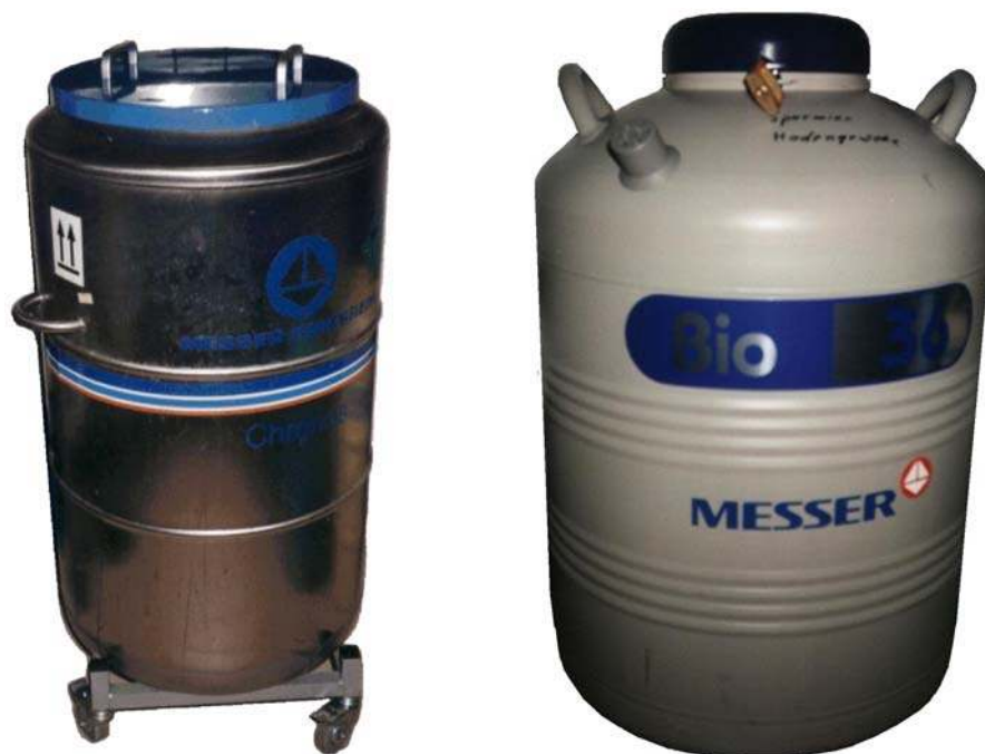
Abb 3.2 Verwendete Kryobehälter. Links: Behälter zur Kryokonservierung der Proben der Stickstoffdampfgruppe (G.II); rechts: Behälter zur Lagerung der kryokonservierten Proben
