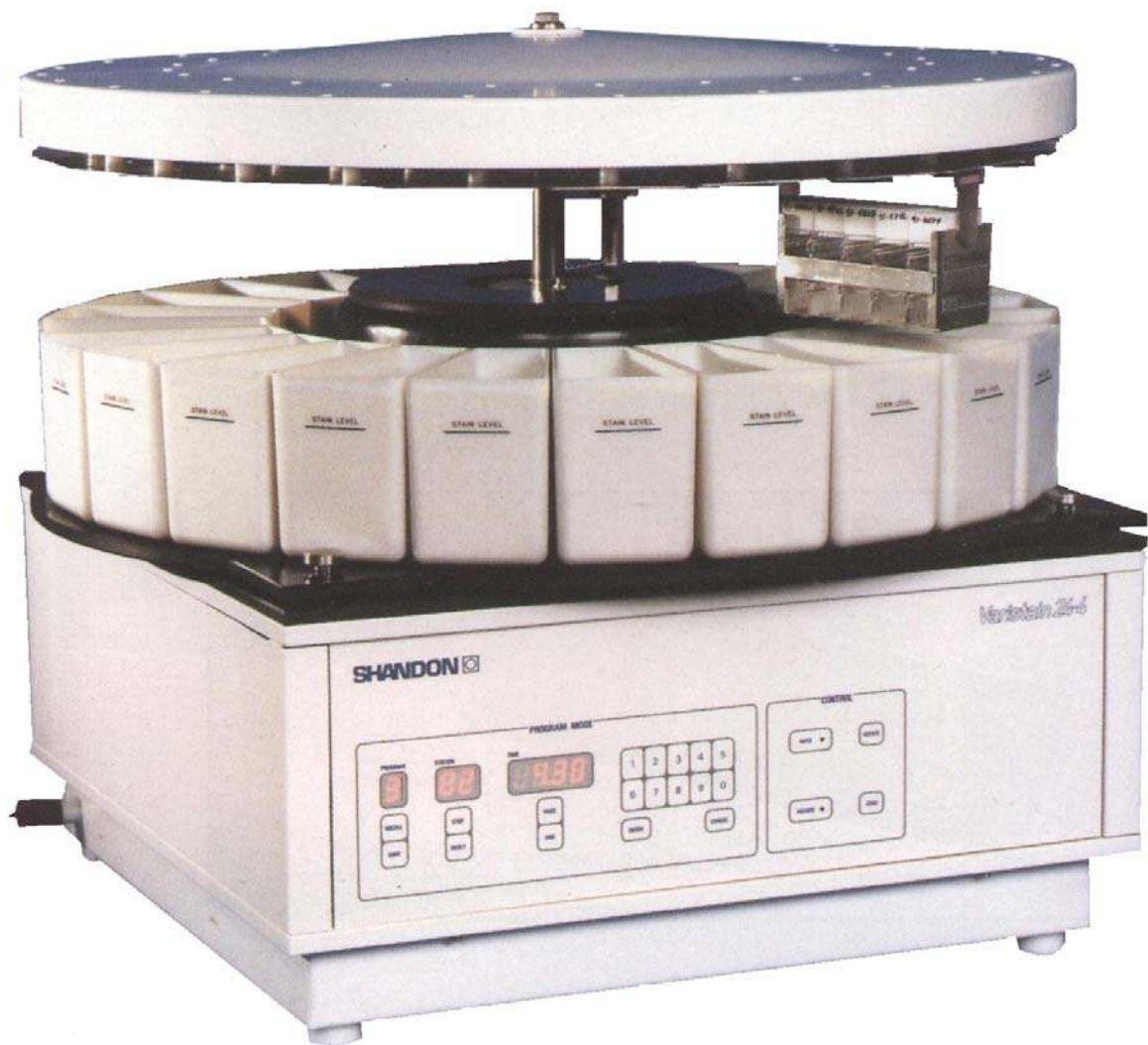
Abb 3.7 Programmierbarer Färbeautomat „Varistain“ 24-4 der Firma Shandon zur Papanicolaou-Färbung der Spermatozoen
