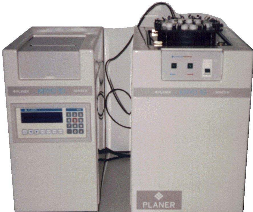
Abb 3.3 Gefriergerät der Serie „Planer“, Kryo 10-3.3/III der Firma Messer Griesheim GmbH. Links: Programmgeber/Temperaturregler; rechts: Gefrierkammer
