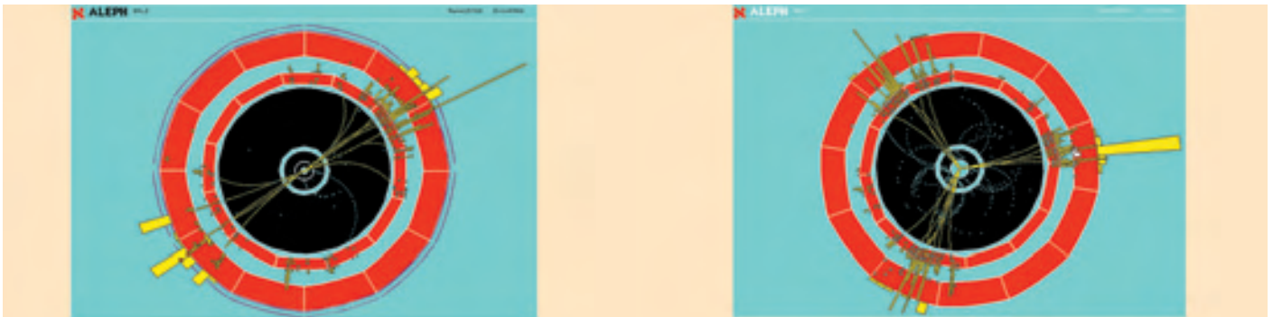
Figura 1. Desintegración de un bosón Z en un par quark-antiquark (izquierda) y en un quark, un antiquark y un gluón (derecha). La inmediata hadronización de los quarks y gluones produce los chorros (“jets”) de hadrones observados en el detector. La proporción de sucesos de tres jets respecto a los de dos permite una medida muy directa de \alpha_s y además “cuenta” el número de gluones respecto al número de colores. Ello permite establecer con gran precisión que QCD corresponde a una teoría con invariancia gauge basada en el grupo SU(3). Los resultados proceden del detector ALEPH del CERN (Ginebra).
