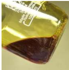
(e) Konzentration analog zu 20 \mu\text{l}/\text{mg}_S \text{Li}_2\text{S}_8 -Polysulfidlösung
