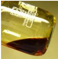
(d) Konzentration analog zu 40 \mu\text{l}/\text{mg}_S \text{Li}_2\text{S}_8 -Polysulfidlösung
