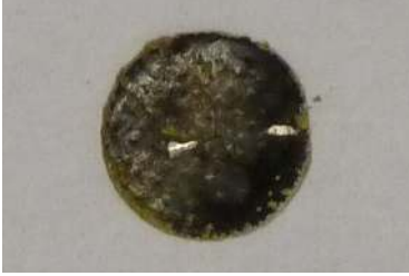
(a) Lithiumanode aus einer Zelle, deren Kathode mit reinem Schwefel hergestellt wurde.
