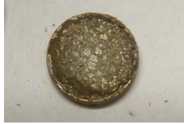
(b) Lithiumanode aus einer Zelle, deren Kathode mit 30 % Rußanteil hergestellt wurde.
