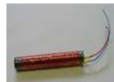
T. STERKEN ET AL. [19], IMEC, 2007: 300 µW, 50 g @ 5 Hz, 5 cm 3
