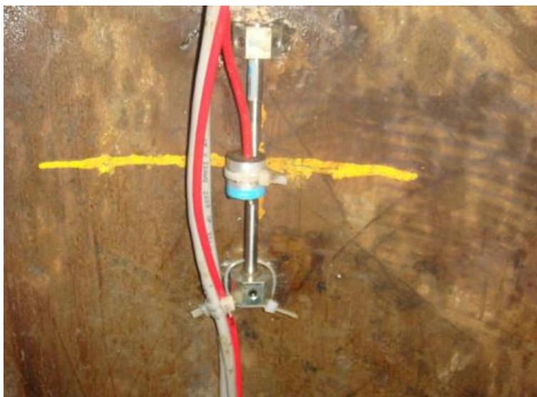
Fig. 24 – Strain Gage em estaca para cravação
