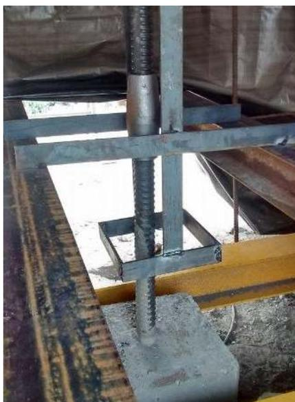
Fig. 71 – Estrutura metálica de suporte dos transdutores de deslocamento
