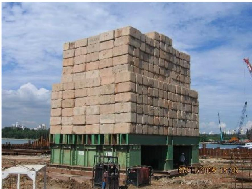
Fig. 34 – Aspeto típico de plataforma sobrecarregada para realização de ensaios estáticos de carga
