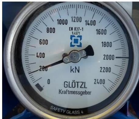
Fig. 73 – Registo fotográfico das leituras efetuadas na célula de carga
