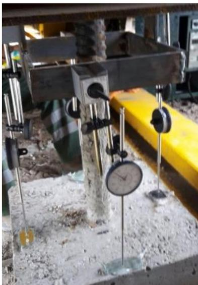
Fig. 70 – Disposição dos transdutores de deslocamento
