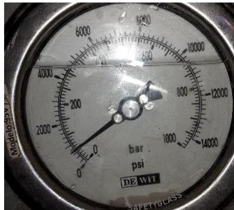
Fig. 74 – Registo fotográfico das leituras efetuadas na bomba do macaco hidráulico
