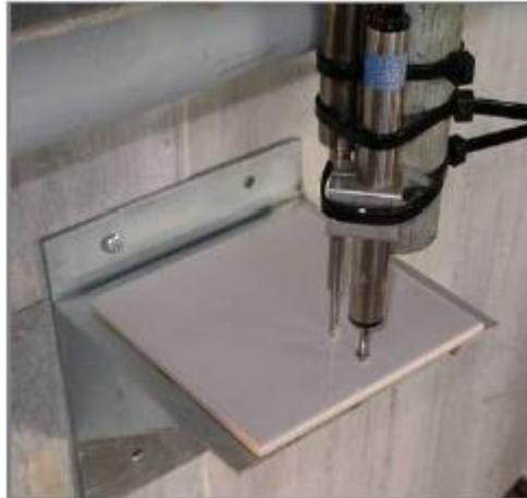
Fig. 21 – LVDT, suporte na estaca e pormenor de fixação
