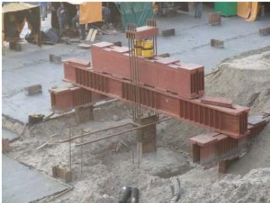
Fig. 37 – Aspeto típico do sistema de reação de um ensaio à extração com uma viga de reação. Fonte: (Handley, B. et al., 2006)
