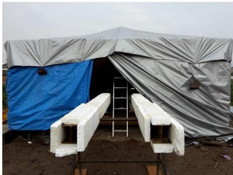
Fig. 69 – Estrutura de proteção e vigas de referência devidamente isoladas
