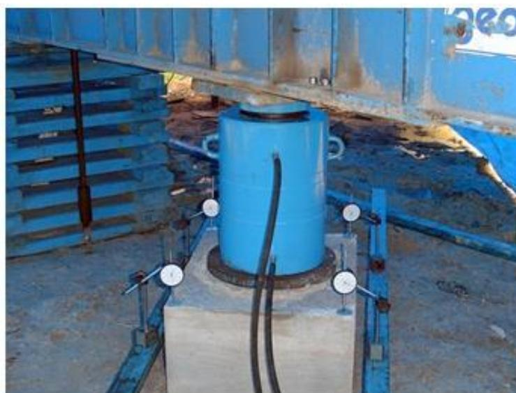
Fig. 20 – Exemplo de montagem dos transdutores de deslocamento
