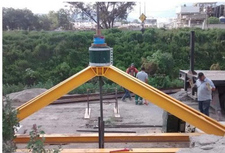
Fig. 67 – Estrutura de reação, macaco hidráulico e célula de carga.
