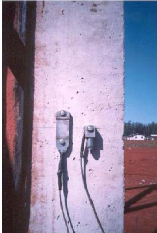
Fig. 13 – Sensores instalados na estaca.
