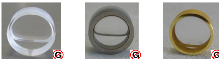
Abb. 4.11: Kennzeichnung von bestandenen und nicht bestandenen Groblecktests für die Messergebnisse in Abschnitt 5.2 (oben). Optisch erkennbare Flüssigkeit in den Gehäusen nach einem nicht bestandenen Groblecktest mit Perfluorcarbon: geklebtes Gehäuse (unten links), lasergelötetes Gehäuse (unten Mitte), kugelgelötetes Gehäuse (unten rechts).
