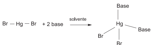
Figura 1. Representação esquemática da reação considerada para o estabelecimento do valor de D_S . Sendo \nu_1 a frequência de estiramento da ligação Hg-Br no \text{HgBr}_2 gasoso e \nu_2 a frequência de estiramento da mesma ligação após reação do \text{HgBr}_2 com as moléculas do solvente (uma base L), formando um composto pseudotetraédrico de fórmula \text{HgBr}_2\text{L}_2 , \nu_1 - \nu_2 = \Delta\nu = D_S
