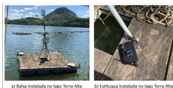
Figura 7. Balsa localizada no lago Terra alta e o nó na balsa coletando dados
