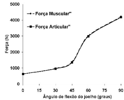
Figura 9. Força Muscular axial e Força Articular axial nos cinco ângulos de flexão do joelho expressas em Newtons (N). Valores positivos indicam compressão articular.
