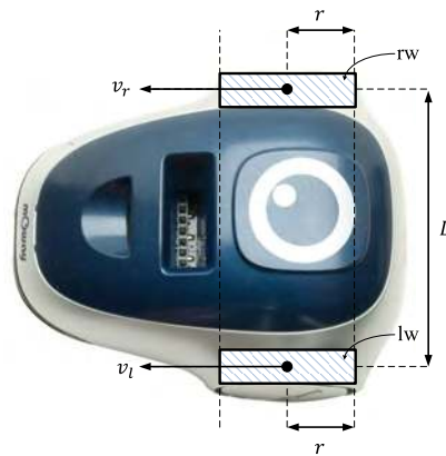
Figura C.1: Robot mOway. Parámetros geométricos y dinámicos.
