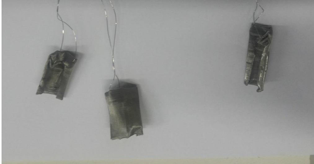
Figura 18. Amostras mantidas em malha de aço para ensaio de fração - gel.
