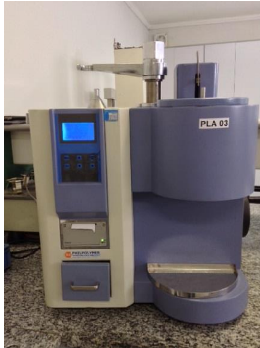
Figura 17. Plastômetro utilizado para análise do índice de fluidez.
