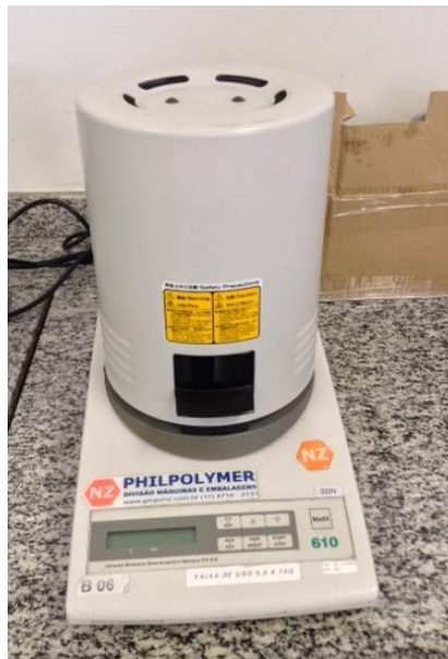
Figura 8. Equipamento utilizado para medir o teor de umidade localizado no laboratório de qualidade da empresa NZ Cooperpolymer.
