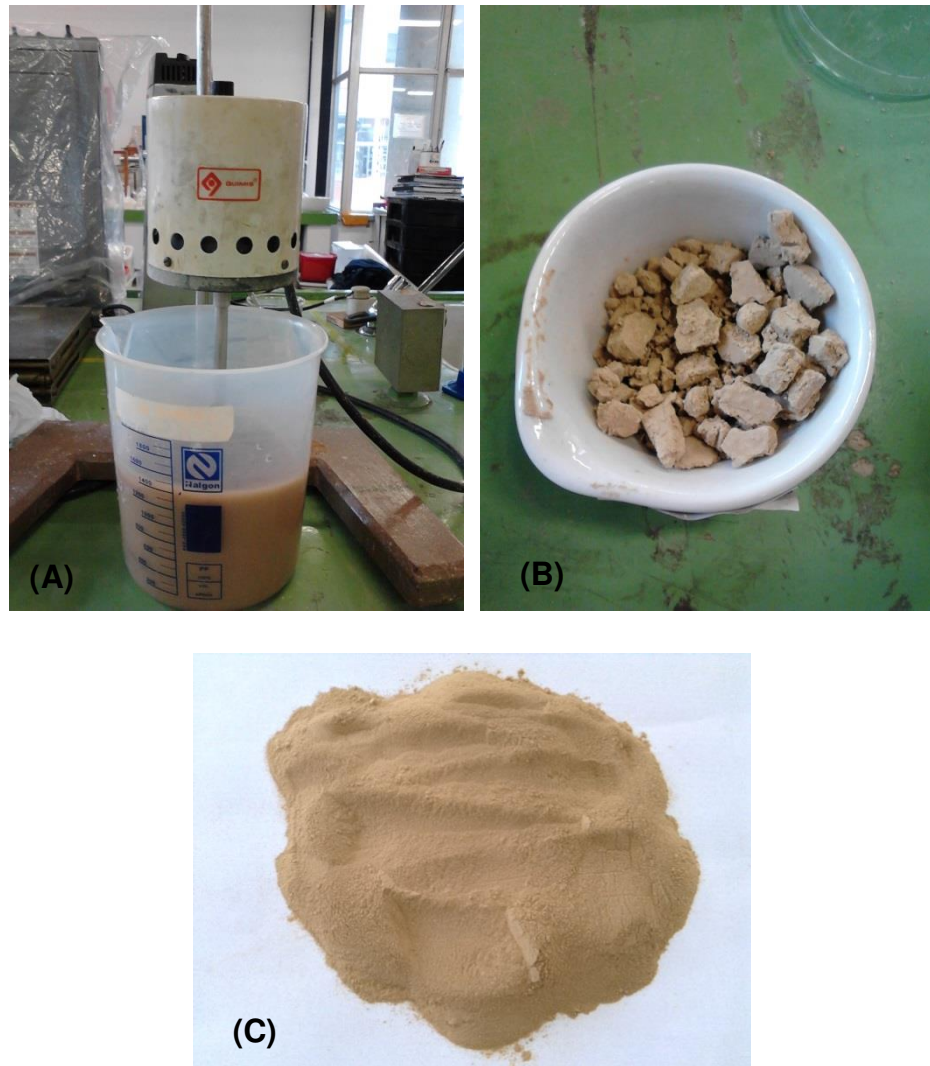
Figura 7. Modificação da argila. (A) argila sendo dispersa em água destilada; (B) argila modificada seca em estufa; (C) argila modifica peneirada.
