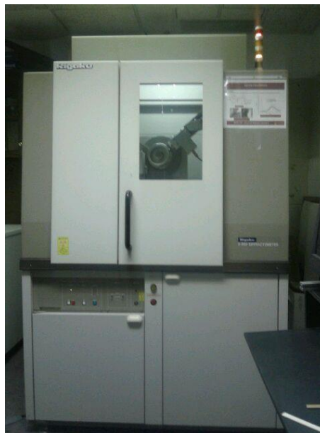
Figura 12. Difratômetro de raios X modelo Rigaku DMAX 2200 do laboratório do Centro de Materiais Avançados da Universidade Tuskegee.
