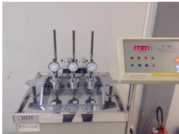
Figura 16. Equipamento para ensaios de HDT do Laboratório de Qualidade da empresa NZ Cooperpolymer.
