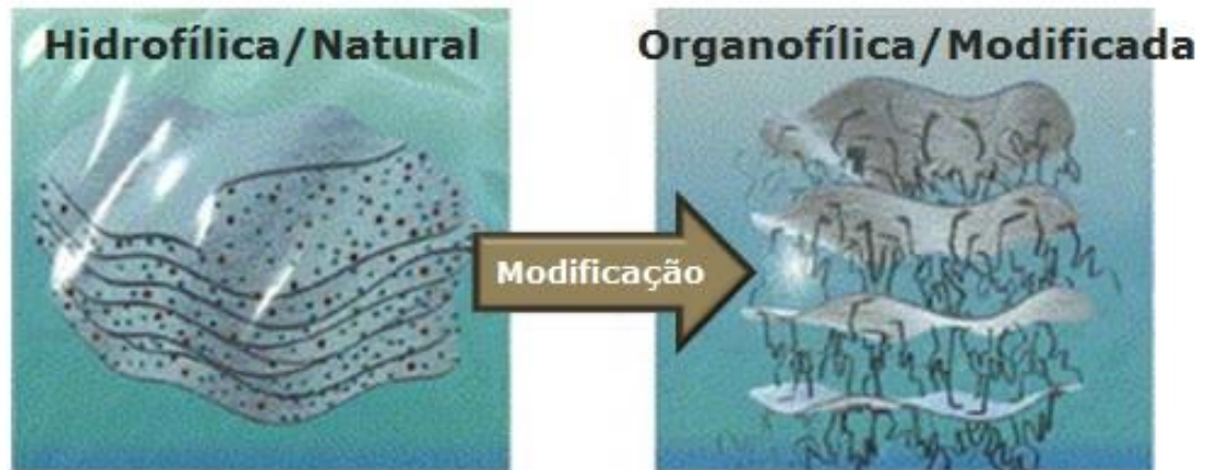
Figura 3. Esquema de troca de íons em argilas através da modificação (adaptado de FISCHER, 2003).
