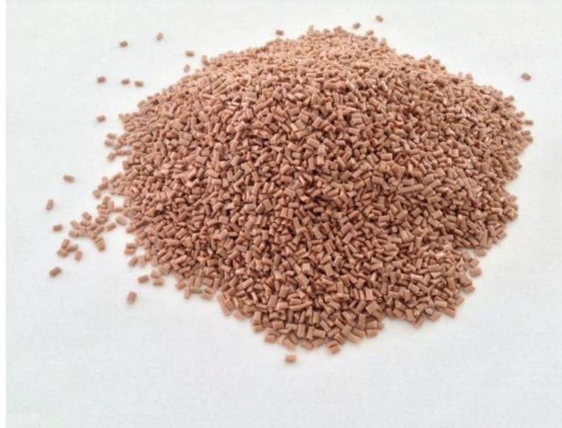
Figura 10. Nanocompósitos de PBT/GMA/3% Argila obtidos no processo de extrusão.
