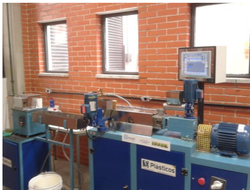
Figura 9. Extrusora utilizada para obtenção dos nanocompósitos.
