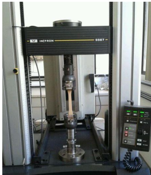
Figura 14. Máquina universal de ensaios Instron durante a realização do ensaio de tração.
