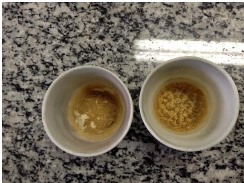
Figura 21. Cadinhos de porcelanas com a argila residual após a queima.
