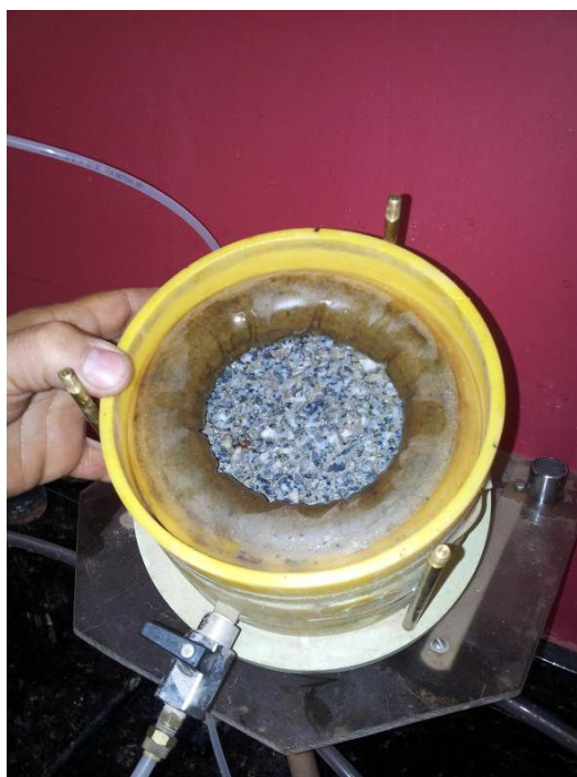
Figura 2.25: Corpo de prova envolto pela membrana flexível
