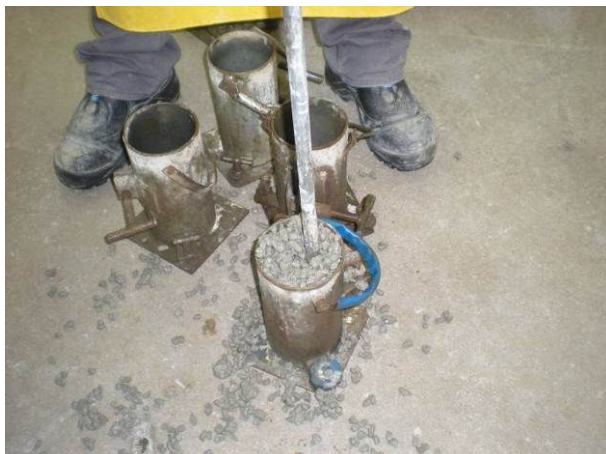
Figura 2.7: Procedimento de compactação de corpos de prova cilíndricos
