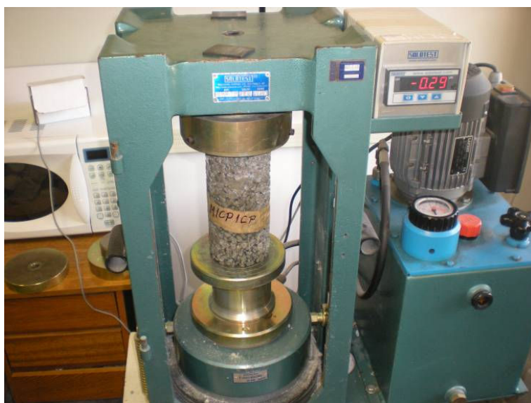
Figura 2.19: Ensaio de compressão uniaxial
