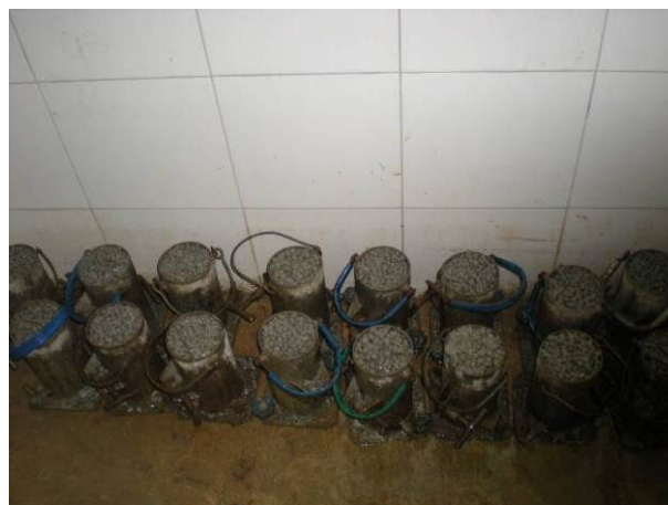
Figura 2.10: Corpos de prova cilíndricos na câmara úmida
