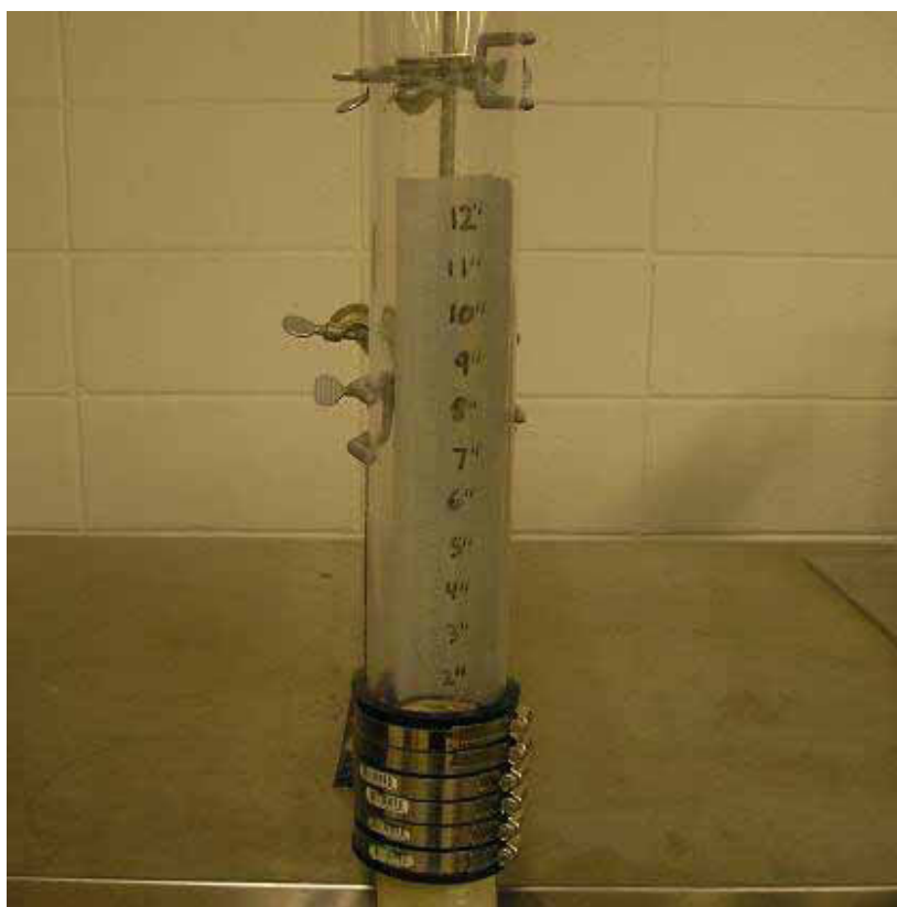
Figura 1.5: Permeômetro de carga variável utilizado para medir a condutividade hidráulica de amostras de concreto permeável (Fonte: SCHAEFER et al. , 2006)
