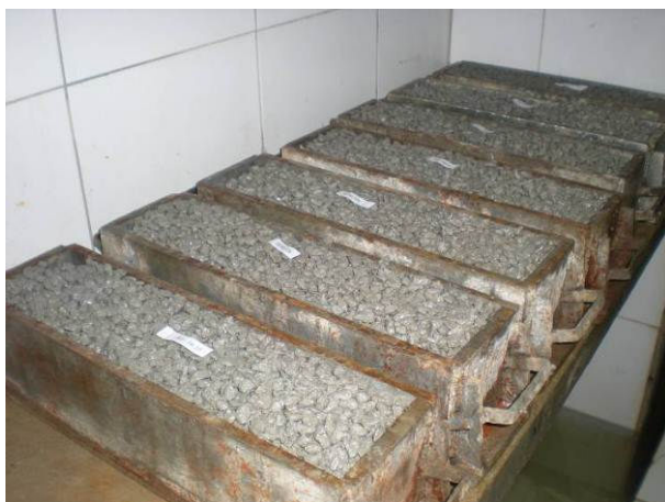
Figura 2.9: Corpos de prova prismáticos na câmara úmida
