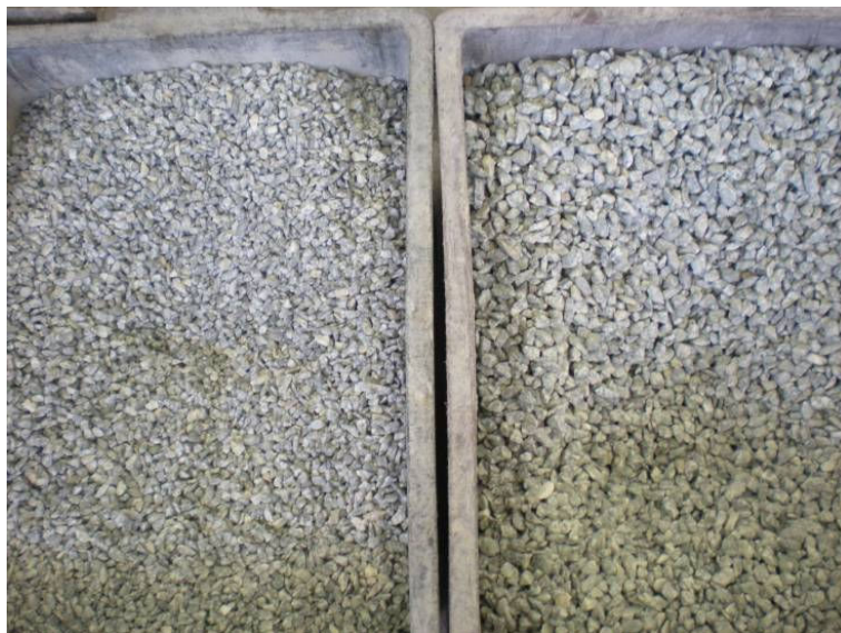
Figura 2.3: Diferenciação entre os diâmetros dos agregados (Esquerda – 4,75 mm; Direita – 6,3 mm)
