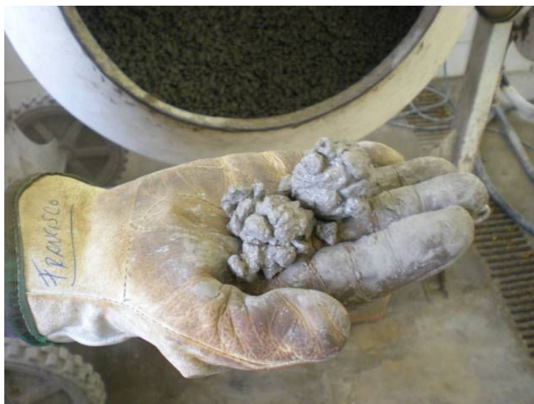
Figura 2.6: Teste visual para controle da mistura
