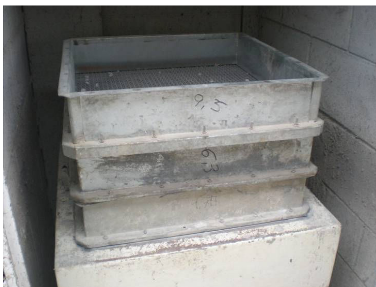
Figura 2.2: Peneiras utilizadas para separação das frações dos agregados
