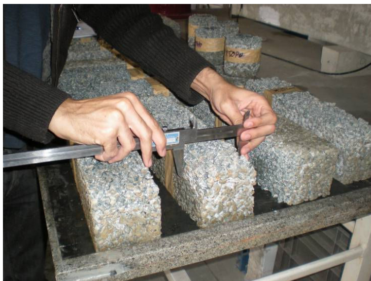
Figura 2.14: Procedimento de medição das amostras
