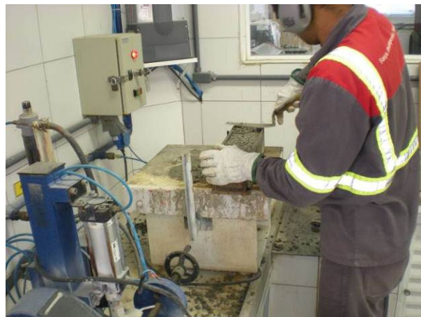
Figura 2.8: Procedimento de vibração dos corpos de prova prismáticos
