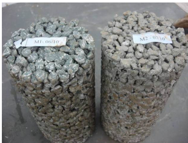
Figura 2.13: Diferença entre os corpos de prova cilíndricos moldados para a mistura M1 (esquerda) e M2 (direita)
