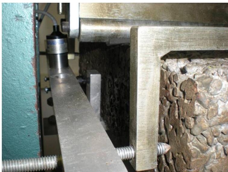
Figura 2.21: Posicionamento do LVDT para obtenção da flecha durante o ensaio de resistência a tração na flexão
