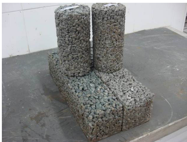
Figura 2.12: Corpos de prova desmoldados
