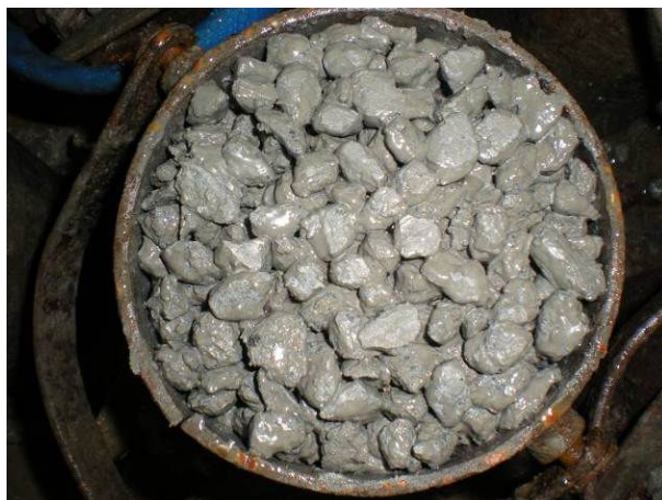
Figura 2.11: Detalhe da estrutura aberta do concreto permeável no estado fresco
