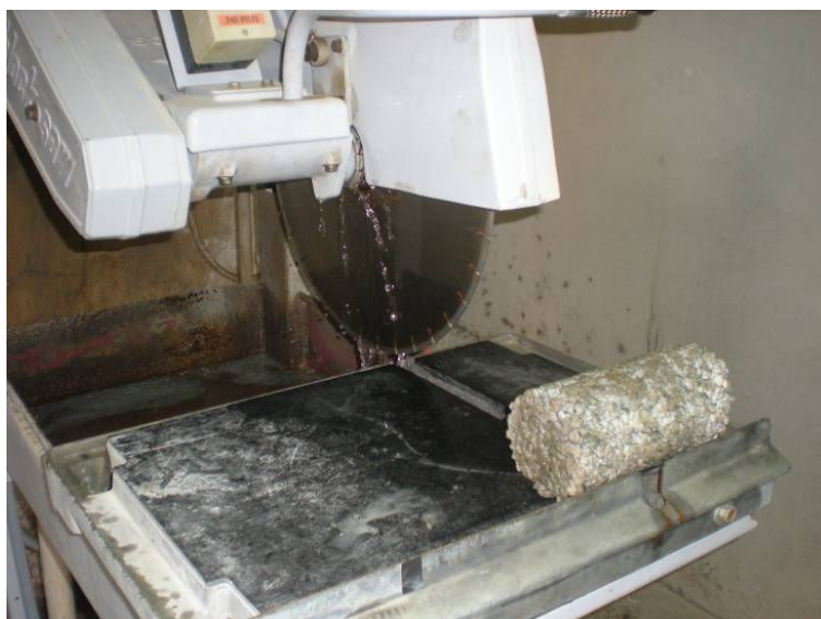
Figura 2.24: Procedimento de corte dos corpos de prova
