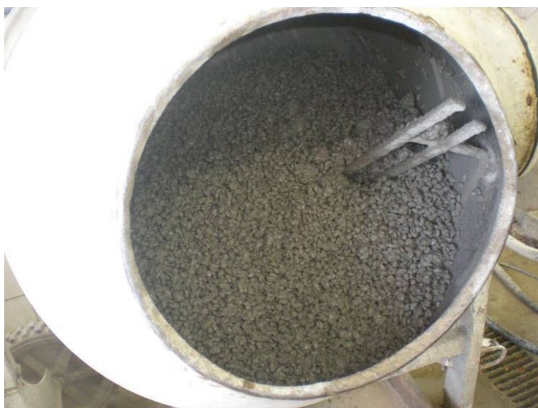
Figura 2.4: Mistura dos componentes do concreto permeável
