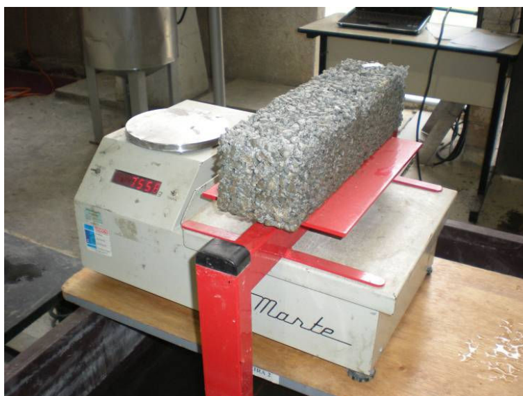
Figura 2.26: Procedimento de obtenção do peso seco
