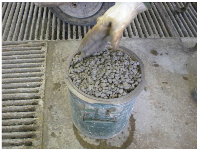
Figura 2.5: Determinação da massa específica aparente no estado fresco
