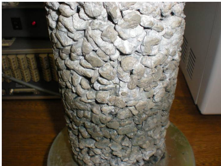
Figura 2.20: Fissuras observadas após ruptura da amostra em compressão
