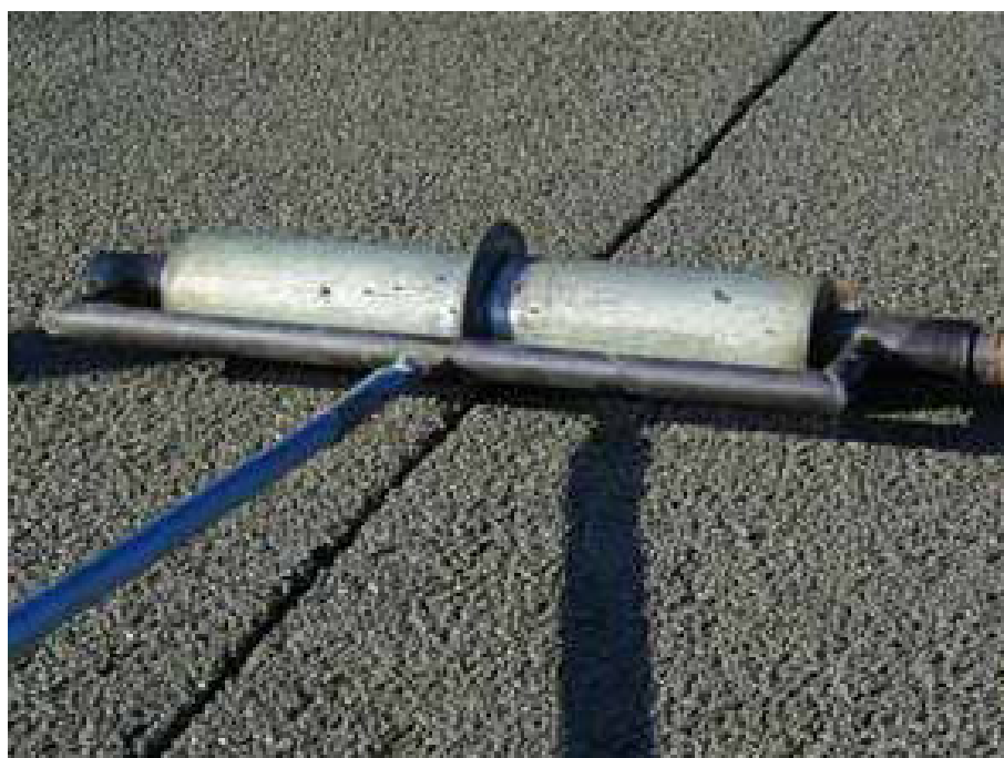
Figura 1.21: Rolo utilizado para fazer as juntas no concreto permeável (Fonte: Youngs, 2005.)
