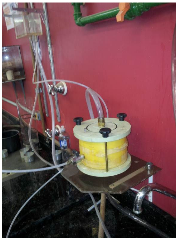
Figura 2.23: Permeâmetro de carga constante
